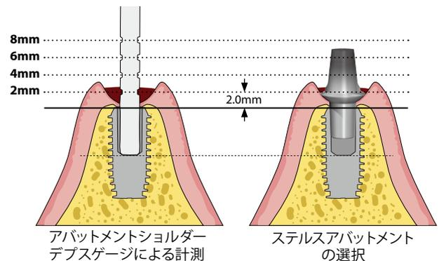
適切な高径のステルスアバットメントを選択するためにはアバットメントショルダーデプスゲージを使用します。ステルスアバットメントは、インプラントの上端からアバットメントの最大膨隆部までが高径です。アバットメントショルダーデプスゲージをインプラント内に挿入し、歯肉マージンまでの高径を測定します。歯肉レベルが目盛りの中間にある場合は、審美上、高径が低い方のステルスアバットメントを選択してください。
